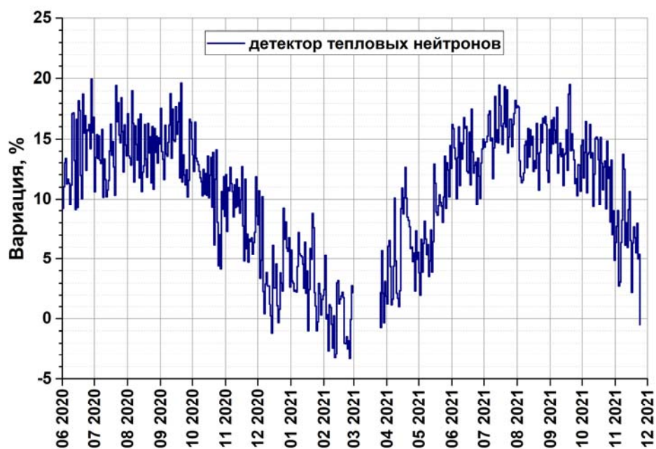
Рис. 16. Профиль счета детектора тепловых нейтронов за 2020-21 г. Использовано суточное усреднение.
