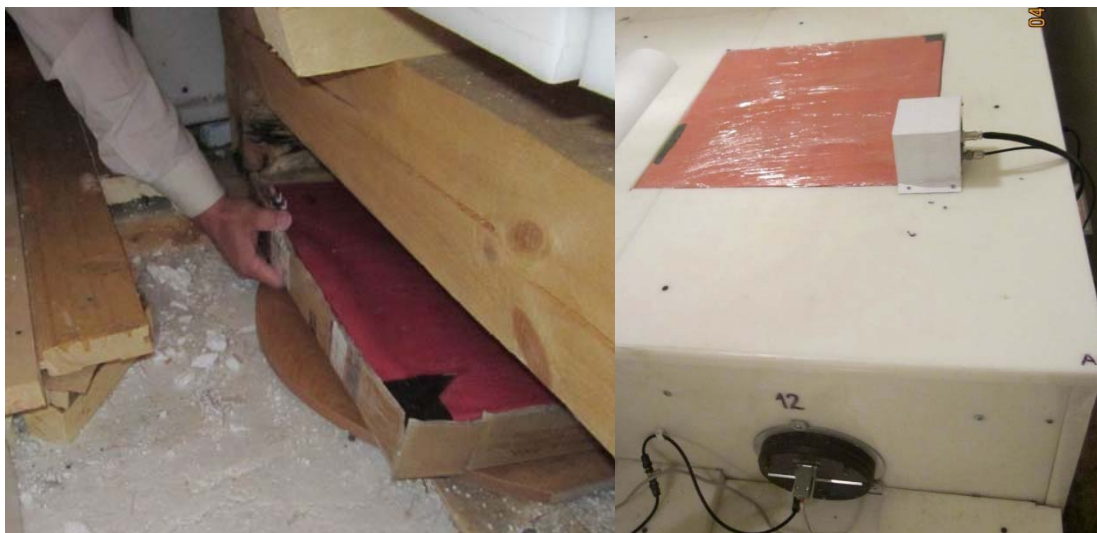
Рис. 20. Установка сцинтилляционных пластин мюонного телескопа. Пластины обернуты в светонепроницаемую бумагу и фольгу. Для исключения возможности случайного протирания их при монтаже пластины были помещены в картонные коробки, которые при окончательной установке удалялись. Слева: размещение нижней пластины под нейтронным монитором. Справа: вид верхней пластины, врезанной в полиэтиленовую защиту нейтронного монитора.
