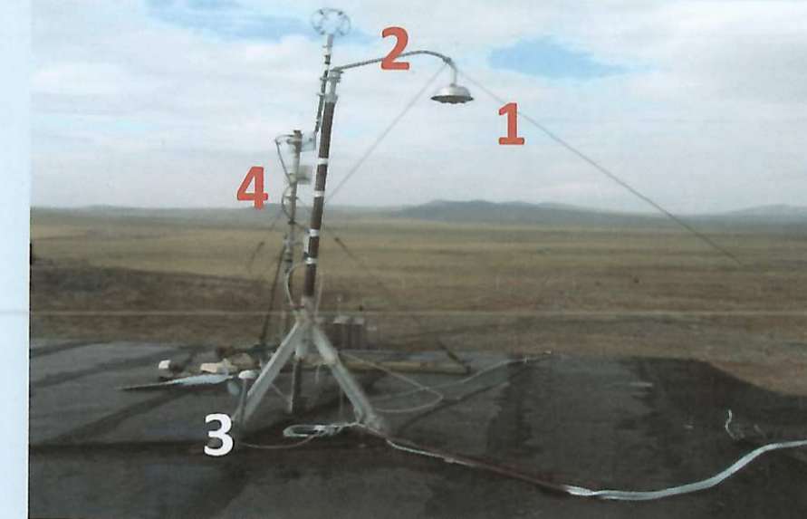
Флюксометр (1), метеостанция (2), GPS-антенна (3) и антенны интернет (4), ПГО Тикси.
